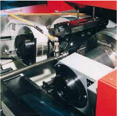
Durchlaufwalzen / Through-feed rolling
