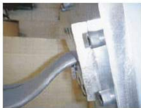
Preform extruded through die 物料經由模頭押出 ダイヘッドによって材料を押出する
